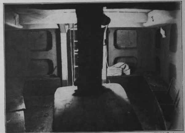
FIG. 36. — POSTE AVANT DE GOÉLETTE On voit la disposition des doubles couchettes.
