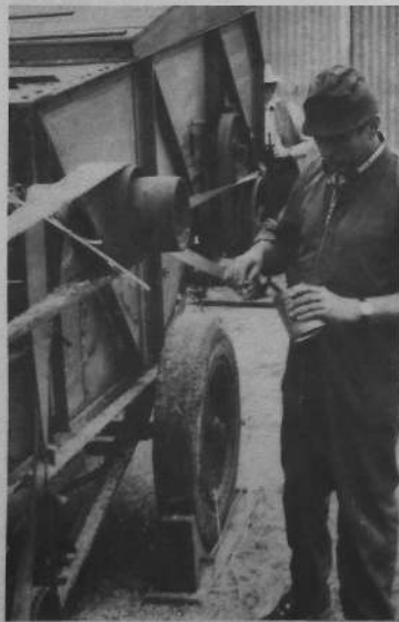
On met de la résine sur les courroies pour les empêcher de "sauter". Leur entretien incombe au mécanicien.
