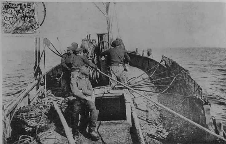
Sur une bisquine de Granville, la manœuvre du moulinet ou « Ouinche » pour remonter une drague à huîtres.
