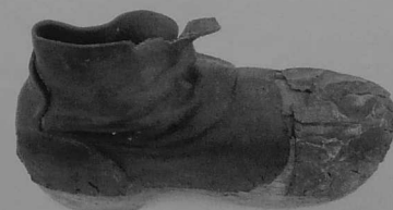
Sabot de sécurité à montant : le bout et la cheville sont protégés grâce à un renfort en métal et un montant en cuir. Collection Les Amis de l'Outil Bièvres (91)
