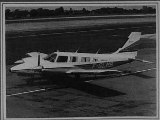
PIPER SENeca III 5 passagers - Vitesse de croisière : 330 km/h Altitude de 1 à 3000 m - Rayon d'action : 1500 km.
