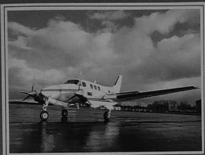
KING AIR 90 5 passagers en V.I.P. - 9 en standard Vitesse de croisière : 400 km/h - Altitude de 6 à 7000 m - Rayon d'action : 1800 km.
