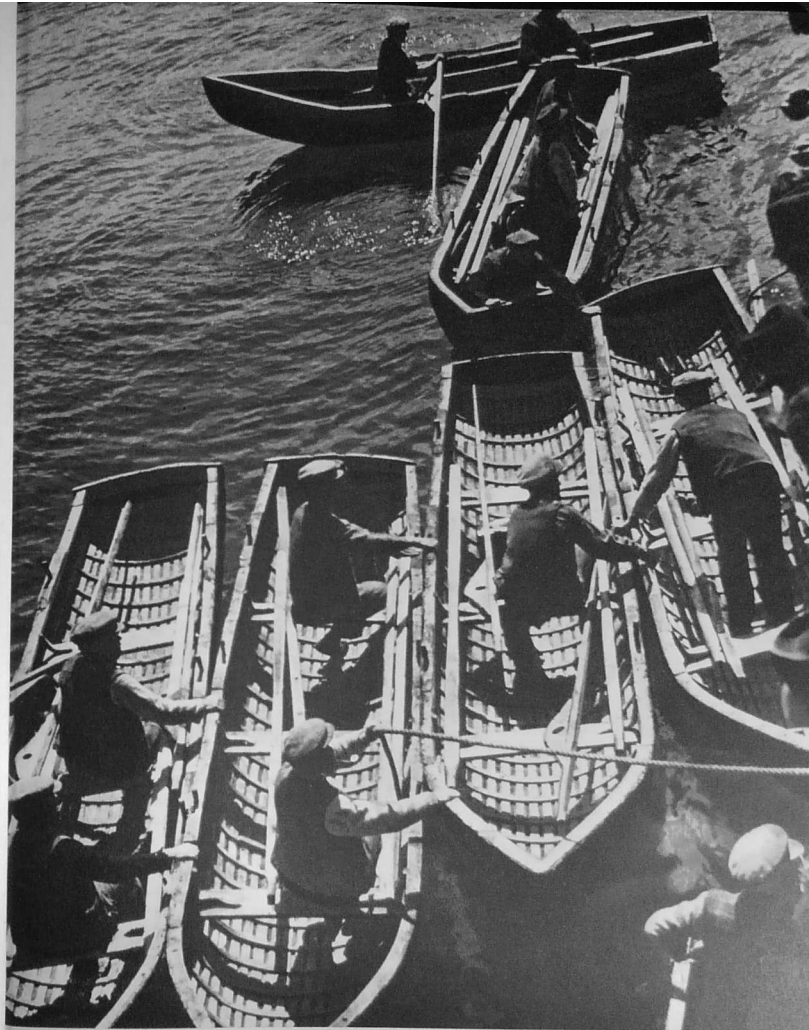
Die irischen Atlantikfischer benutzen seit Jahrhunderten das „Curragh“, ein außergewöhnlich seetüchtiges Boot, dessen leichtes Holzgerippe mit geleerter Leinwand bespannt ist. Photo: Boed Fülle
