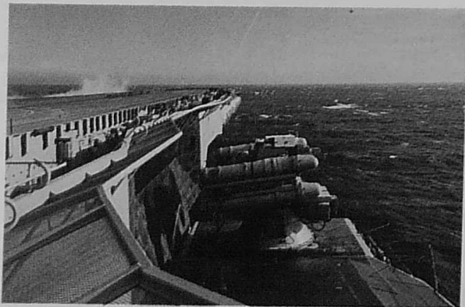
Protection par matériaux ABLADUR d'un poste de tir de missile
