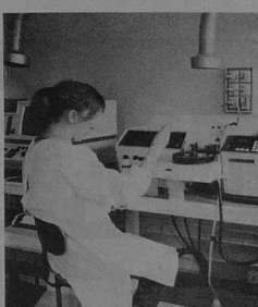
Dosage des métaux lourds (cuivre, plomb) par absorption atomique de flamme - ENSF.
