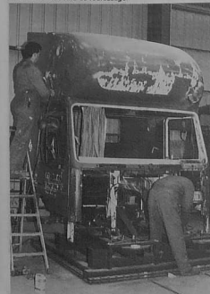
Une cabine en cours de redressage.
