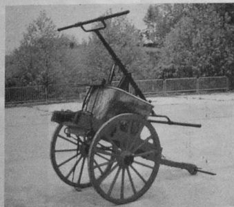
Pompe à bras semblable à la « Consolante » ou à la « Gouët »
