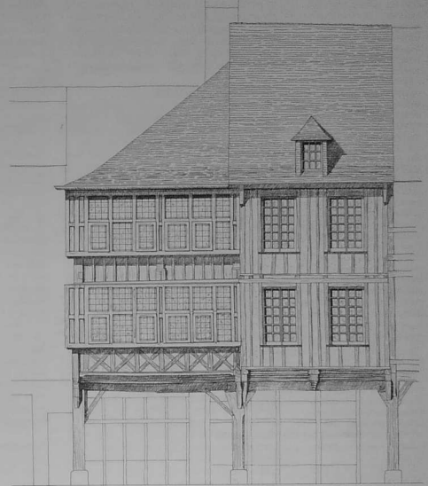
Dinan - Place de l'Apport. Mutilation d'une façade-vitrine. Un galandage placé au nu de la colonne ferme le jour de la baie, mettant à l'extérieur l'élément poteau, jadis intérieur. Il s'agit ici d'un poteau cornier recevant une poutre placée dans la bissectrice des deux faces.
