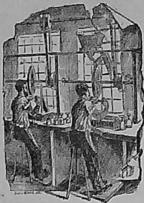
FIG. 26. — Taille du cristal. — Pour tailler le cristal, c'est-à-dire pour faire sur les verres, les carafes, etc., les facettes appelées tailles , on se sert de moules de fer, de grès ou d'acier enduits de sable ou d'émeri en poudre sur lesquelles on appuie l'objet à tailler. Le cristal est usé par le frottement; on le polit ensuite avec différentes poudres minérales.
