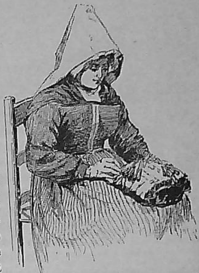
FIG. 177. — Dentellière. — Le métier à dentelle se nomme carreau ; il est formé d'une carcasse en bois recouverte de feutre sur lequel un morceau de drap est tendu. Le dessin de la dentelle est décalqué sur une bande de parchemin ou de papier de couleur. Le nombre des fuseaux varie suivant la largeur de la dentelle. Voici comment s'y prend l'ouvrière : elle plante une rangée d'épingles en tête de son calque, enroule autour de chaque épingle deux ou trois tours de chaque fil, fait un nœud et entremêle les fils pour former le tissu et ainsi de suite pour toutes les épingles.
