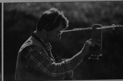
Photo de gauche, ce phragmite aquatique va être équipé d'une puce électronique. Photo de droite, l'antenne reliée à un récepteur permet de localiser les signaux émis par la puce électronique.
