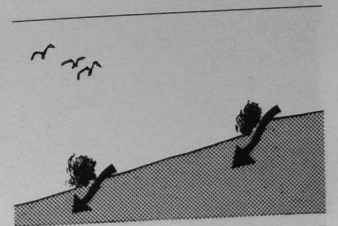
Schéma illustrant la circulation des eaux sur des terrains en pente barrés par des haies en courbes de niveau : l'alimentation des nappes est mieux assurée, l'érosion superficielle bloquée, les haies participent à l'élimination des nitrates entraînés par le ruissellement, l'équilibre hydrologique est assuré au cours des saisons.
