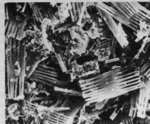
Fig. 7. Vue au microscope électronique à balayage (grossissement : 1000) d'un échantillon de sédiment du lac de l'Arguenon formé essentiellement d'une diatomée pennée : Fragilaria crotonensis , associée à quelques diatomées centriques.
