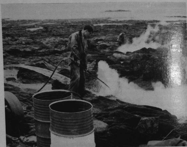
Fig. 5. — Emploi de jets de vapeur pour le nettoyage des rochers à Loequirec. Juin 1967.
