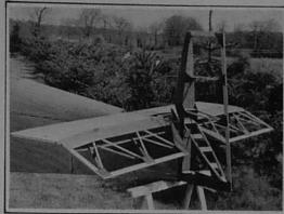
Empennages de B.B. JODEL avant entoilage
