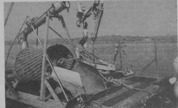
Un cribble tambour rotatif entraîné par deux roues arrière, sous le simple effet du remorquage. (Photos Christian Marie).
