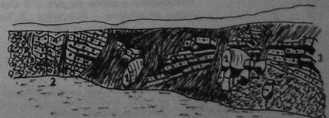
Fig. 68. - Croquis de situation et front de taille : carrière des Rochelles. 3. Membre de Courouët. - 2. Conglomérat de base du Paléozoïque. - 1. Calcaire briovérien.
