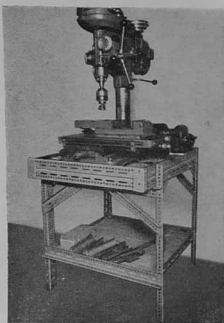
Poste de travail réalisé avec quelques barres de DEXION.
