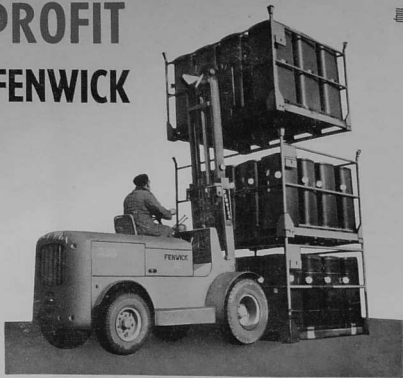
Chariot à fourche Yard-King 80 à essence, équipé d'un coupleur hydraulique permettant une grande souplesse de manœuvre, sans fatigue de l'embrayage.
