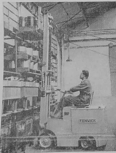
Ce Junior-Lift électrique lève et gerbe sur palette, à 3 m 30, une charge de 1000 kg.
