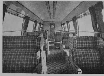
La voiture pendulaire de la S.N.C.F. (ci-dessus), dont la caisse s'incline jusqu'à 15 degrés, pour parcourir des courbes à 160 et même 180 km. à l'heure. Elle est aménagée (ci-dessous) pour le transport de trente-deux passagers.
