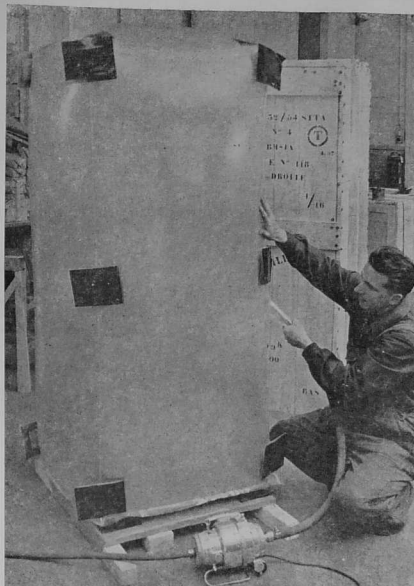
Un emballage étanche : c'est ce qui garantit le contrôle par gonflage pendant vingt-quatre heures (ci-contre). Ci-dessous les logements du personnel SFR à Cholet. (Documents CSF)
