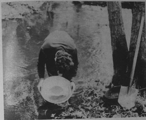
Fig. 38. — Opération du bateage. Récupération des minéraux lourds au fond de la batée. Auparavant, le gravier a été prélevé à la pelle et tamisé au-dessus de la batée.
