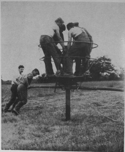
Fig. 39. — Exploration des alluvions à la sondeuse Banka. (Photo J. Guigues)
