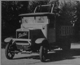
L'un des premiers camions de transport par route, motorisé et à pneus pleins. Camion Berliet type CBA.9 - Année 1920 - Carrosserie avec benne à cables, moteur 4 cylindres type Z de 25 H.P. allumage par magnéto, boîte à 4 vitesses et 1 marche arrière. Transmission par chaînes, charge utile : 5 000 Kilogrammes.
