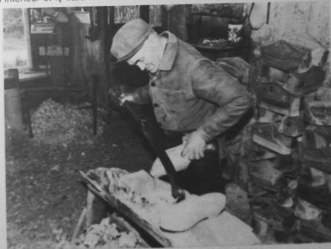
On affinait l'extérieur avec le paroir, comme le fait ici M. Chéenne.
