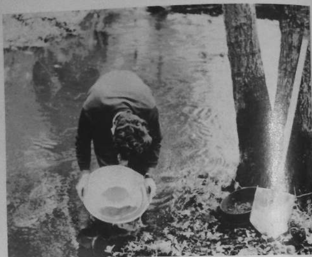
Fig. 38. — Opération du bateyage. Récupération des minéraux lourds au fond de la batée. Auparavant, le gravier a été prélevé à la pelle et tamisé au-dessus de la batée.
