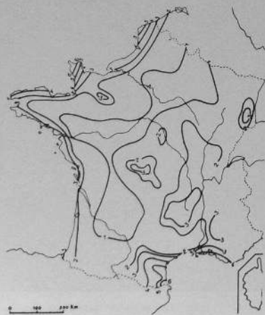
Fig. 5. — Répartition de l'énergie apportée par le vent en kilowatts/heure par mètre carré et par an (d'après SERRA)
