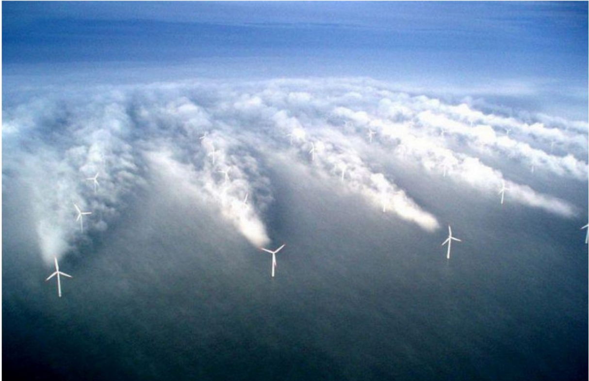
Figure 16 - Phénomène de traînée à l'arrière d'éoliennes
