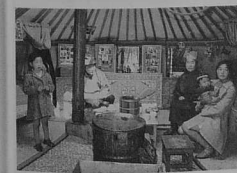
Intérieur d'une yourte mongole. L'ossature est constituée de piliers en bois (généralement du saule) appelés Khaza et réunis au sommet pour soutenir la coupole (ou Toona) centrale. Le tout est recouvert de peau et de tissu tendus par des cordes de crin.
