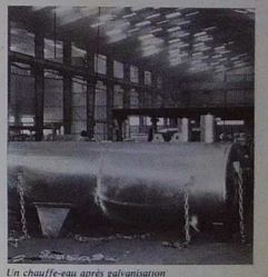
Un chauffe-eau après galvanisation
